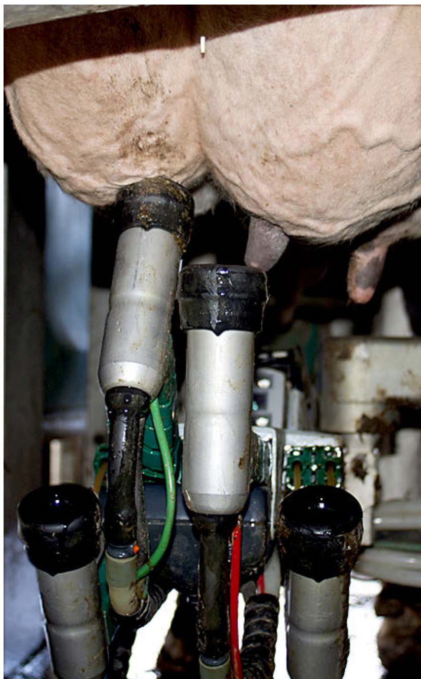
El robot detecta el exceso de células somáticas en la leche de una ubre y la desecha.
