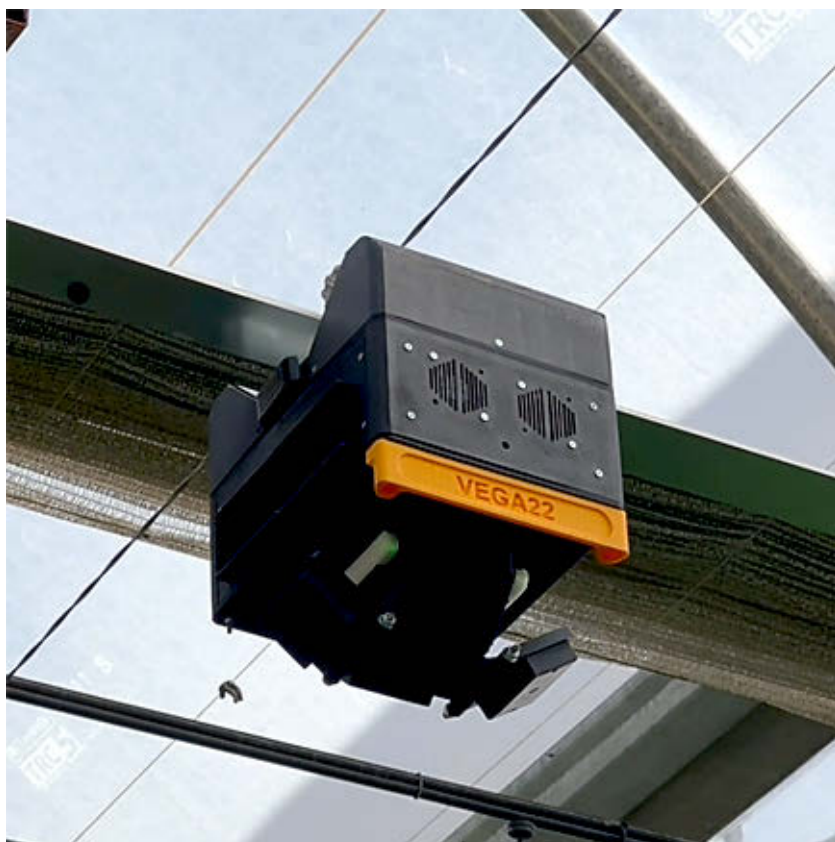
El Vega 22 se adapta a todo tipo de invernaderos y circula por el techo.
